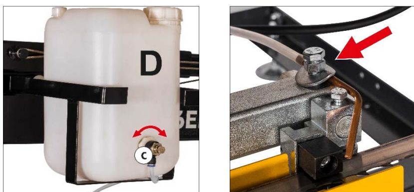
Abb. Bandsägeblatt kühlen
