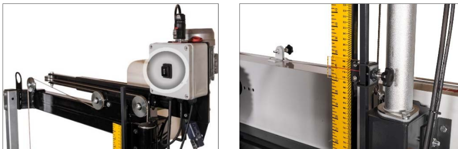
Abb. Sägekopf heben und senken
