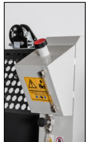
(q) Schmiersystem Tank mit Dosierventil
